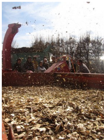
< Le broyeur à branches (1 er type utilisé, à couteaux) et le broyat fin obtenu
