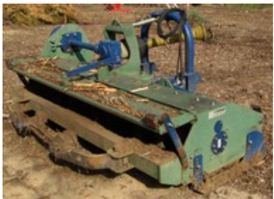
< Le broyat grossier obtenu en roulant sur les andains avec le gyro-broyeur
