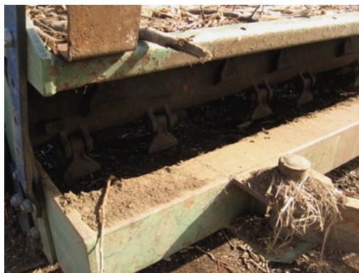
< Le broyeur à marteaux, type gyro-broyeur (matériel utilisé actuellement)
